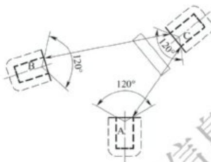
图 5.3.5-5 覆土库方位关系图：1. 每个仓库均为前面到前面
