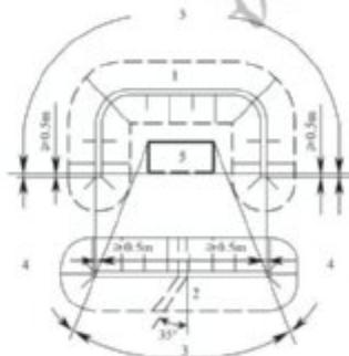
图 5.4.1-1 标准防护土堤的平面防护范围
