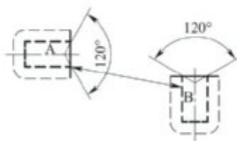
图 5.3.5-4 覆土库方位关系图:B对A——侧面到前面(无防护)
