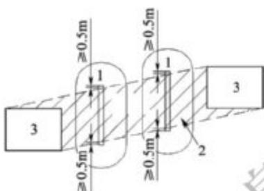
图 5.4.1-2 一字形防护土堤的平面防护范围
