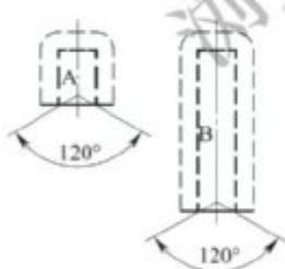
图 5.3.5-7 覆土库方位关系图：B 对 A——侧面到前面(无防护)
